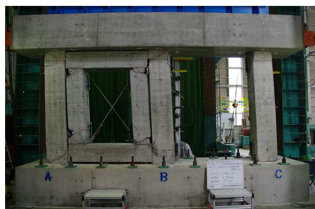
試験体 II-3 (10 \delta y -1回目引)
