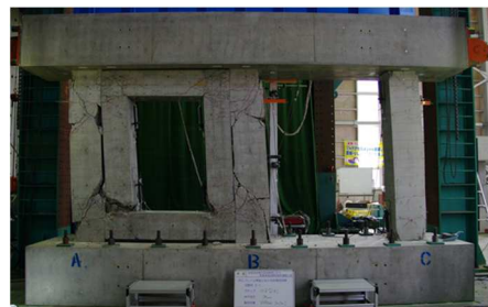
試験体 II-1 (10 \delta y -1回目引)
