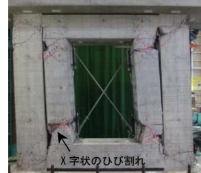
試験体 II-2 (10 \delta y -2回目引)
