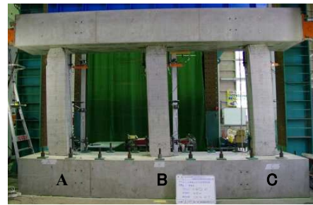
試験体 I (10 \delta y -1回目引)
