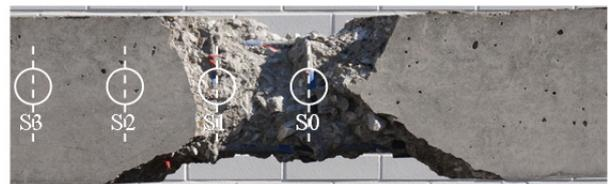
写真-4 損傷部分とひずみゲージ貼付位置(実験 3-1)
