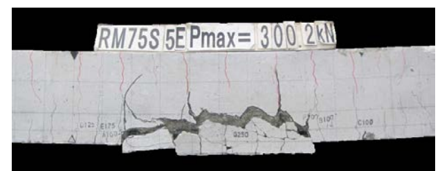
写真-2 最終破壊形状 (RM75S5E(5 年時)・純曲げ区間)
