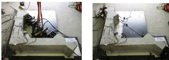
(1) 開方向の載荷 (2) 閉方向の載荷
