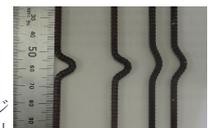
写真-5 座屈後の鉄筋
