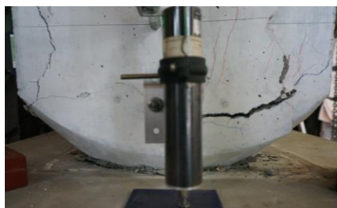
写真-2 柱脚部の破壊状況
