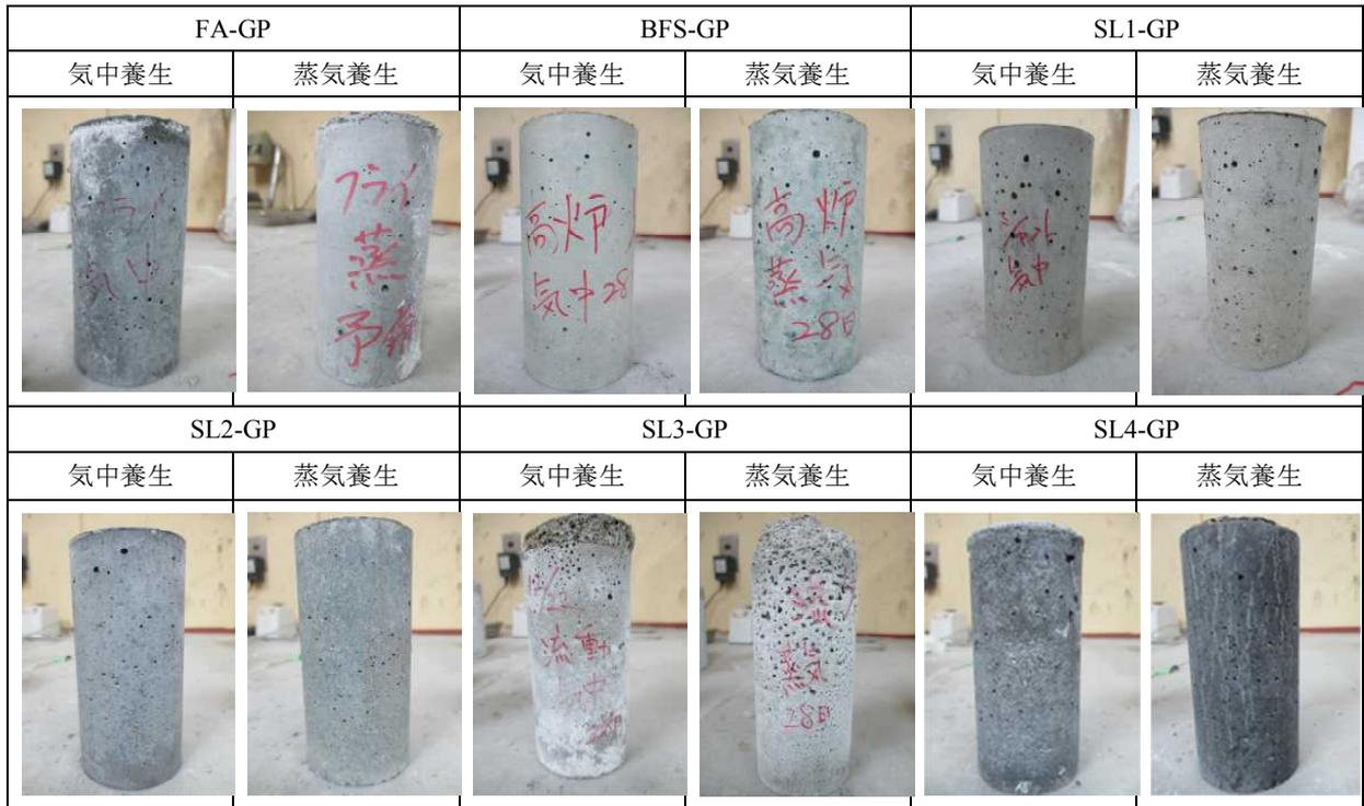
写真-1 ジオポリマーモルタルの外観写真
