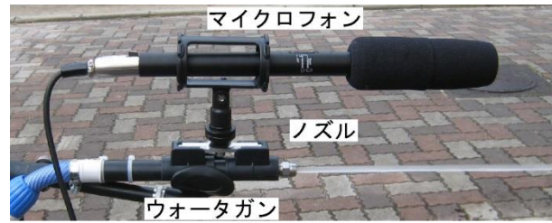
図-4 ウォータガンとマイクロフォン
