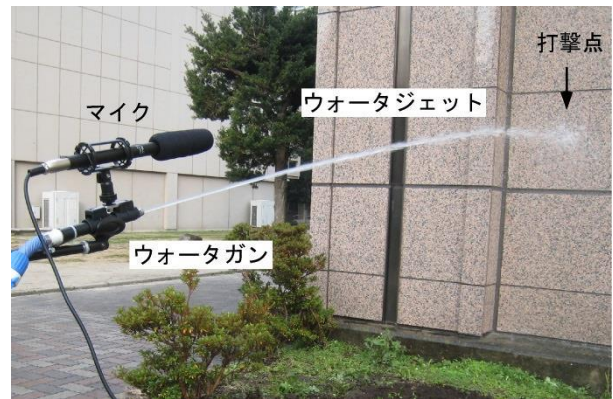
図-13 水撃音響法による外壁タイルうき検知試験
