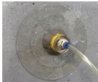
図-1 シール法による測定 (外径 75mm)
