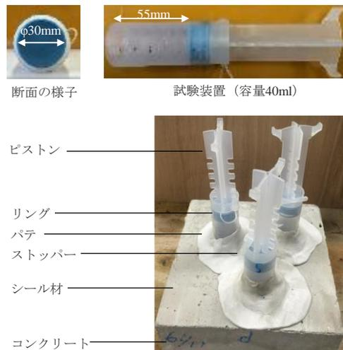
写真-1 試験装置および測定の様子
