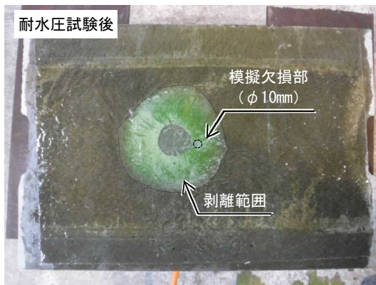
写真-3 試験後のFRPシート表面（欠損φ10mm）
