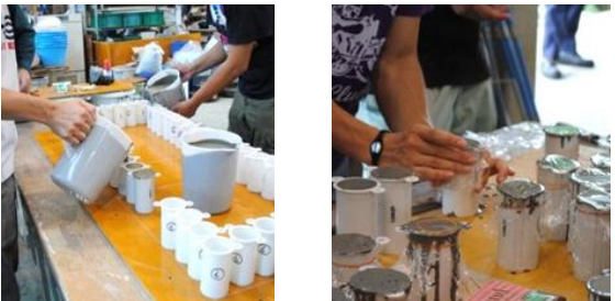
グラウト材打設およびラップ封緘
