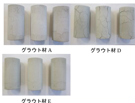
写真-4 900℃加熱試験後の供試体外観状況
