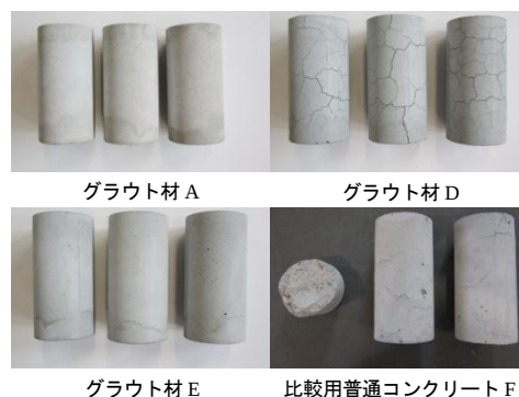
写真-3 600℃加熱試験後の供試体外観状況
