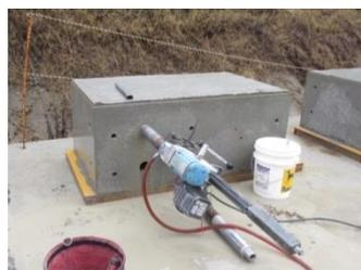
写真-3 コンクリートコア採取状況
