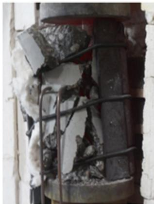
写真 - 1 180Mの加熱中破壊 (加熱温度300°C)
