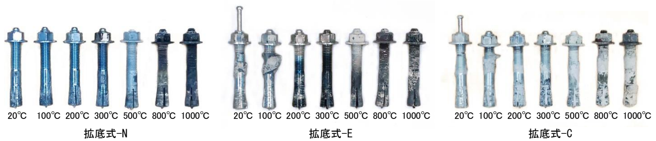
写真-3 加熱および引抜き試験後の拡底式アンカー
