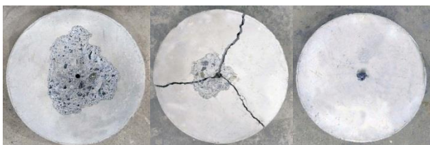
写真-2 引抜き破壊形状
