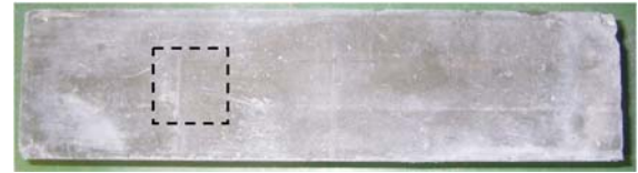
図-5 高炉スラグ細骨材を用いたコンクリートの凍結融解試験後の表面（凍結融解 99 サイクル後）
