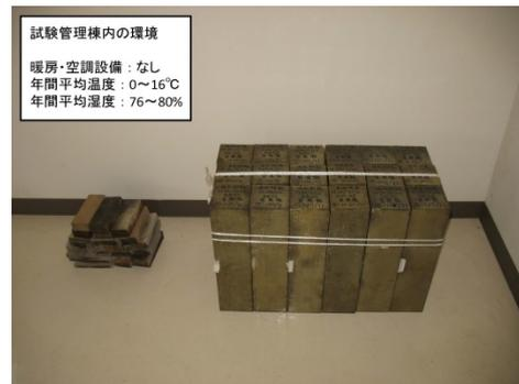
写真-2 屋内保管の状況（実験場内の試験管理棟）
