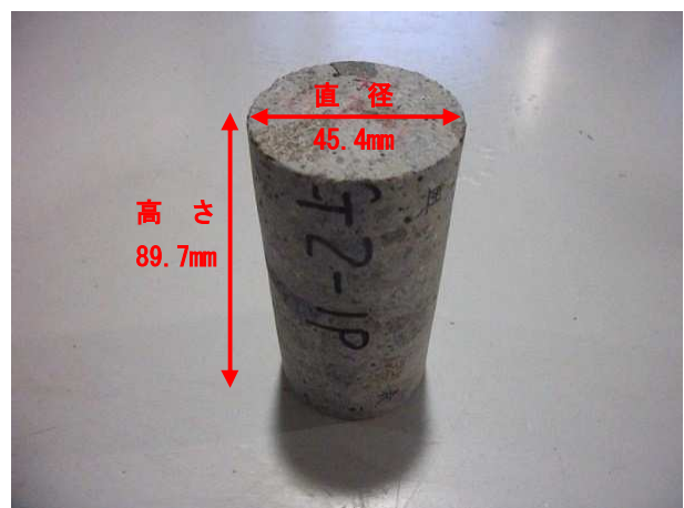
写真-3 試験体形状 (A 橋りょう G2-1P)
