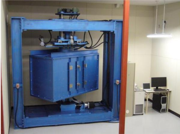
図-3 開発した X 線 CT 装置の外観
