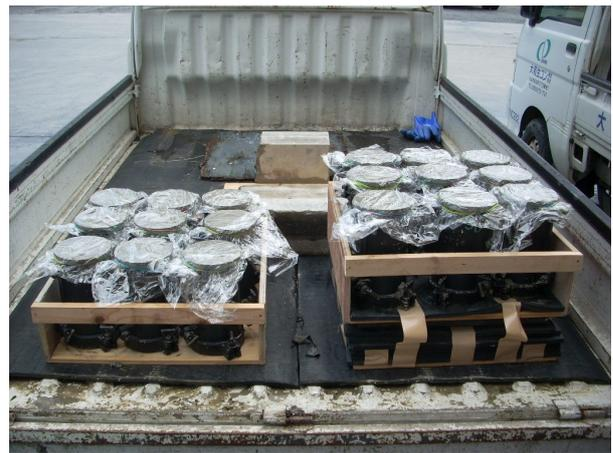
写真-3 減振対策状況（右側、実験 2 及び 3）
