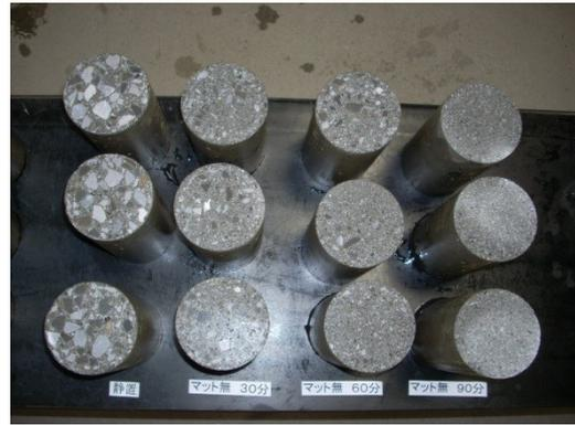
写真-4 減振対策無しの供試体研磨状況
