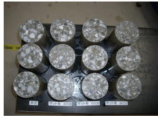
写真-5 減振対策有りの供試体研磨状況
