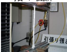
写真-9 引張試験状況
