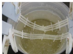
写真-8 セメント飽和溶液浸漬状況
