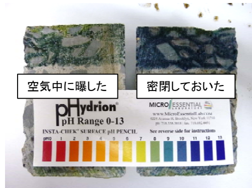
図-7 高湿度・密閉空間内でのpH低下測定結果
