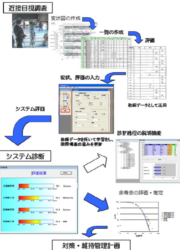
図-3 近接目視点検結果を利用した対象橋梁の診断フロー
