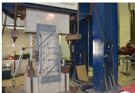
写真-4 試験体および変位計セット状況
