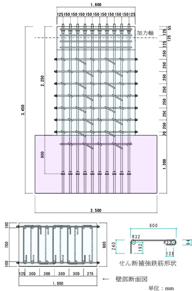
図-2 試験体配筋図
