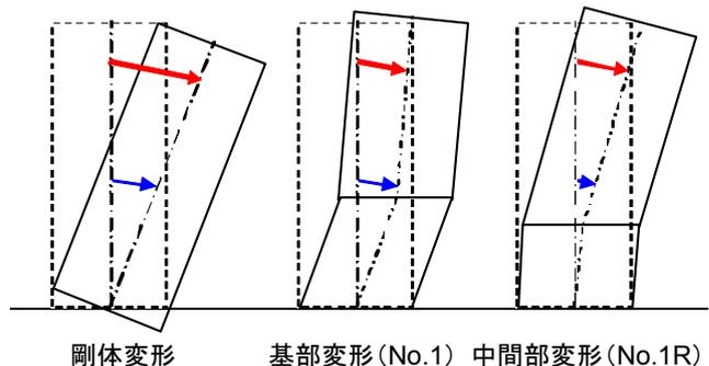
図-10 補修による剛域変化のイメージ
