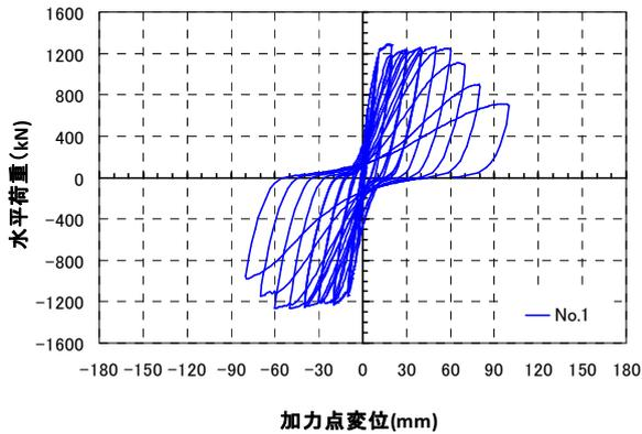
図-5 No.1 荷重変位履歴曲線
