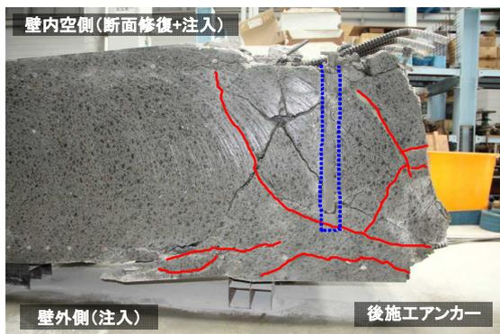
写真-5 壁部の切断面
