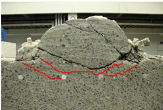
写真-6 壁基部およびスタブ部の切断面
