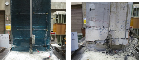
a)No.3（炭素繊維補強） b)No.4（CF 複合パネル補強）
