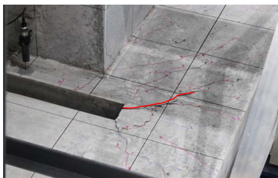
写真-1 +1/50(1) サイクル時試験体写真(試験体 No. 1)
