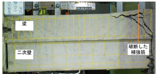
図-16 SP-S5 破壊状況
