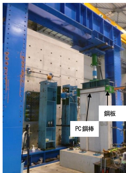
図-1 載荷装置概要
