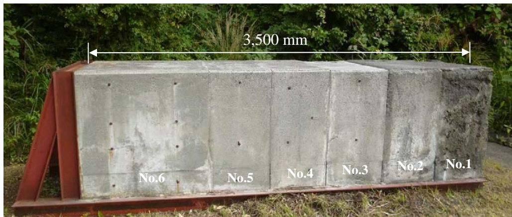
写真-1 強度が異なる長尺部材の外観
