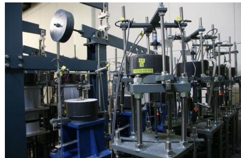
写真-2 クリープ試験状況
