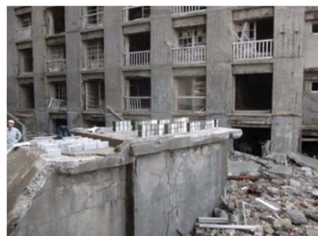
写真-1 暴露試験体の設置状況 (59号棟外)
