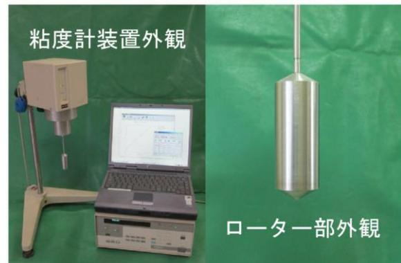
図-1 粘度計およびローターの外観
