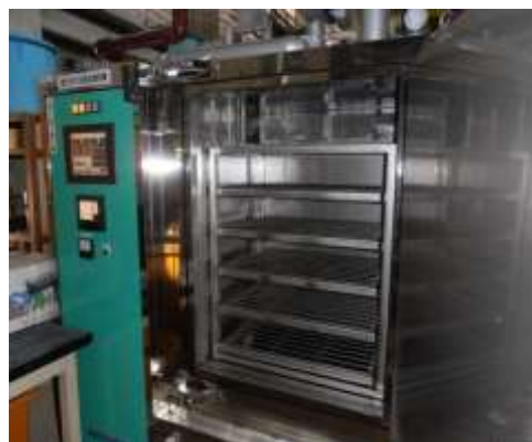
写真-2 複合劣化促進試験機(塩水噴霧)
