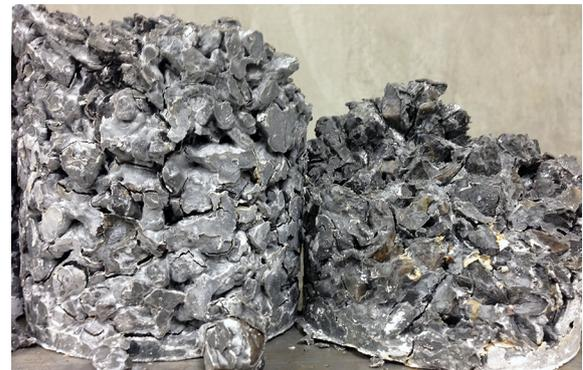
写真-2 30wt.%のCaCl<sub>2</sub>aq浸漬によって崩壊したPOC供試体の例（実験2, FA15, 浸漬74日）
