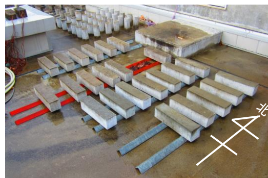
写真 - 1 供試体の曝露の様子 (降雨時)
