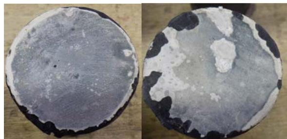
図-8 BB 供試体外観(左:  $Na_2SO_4$ 5%, 右:  $MgSO_4$ 5%)
