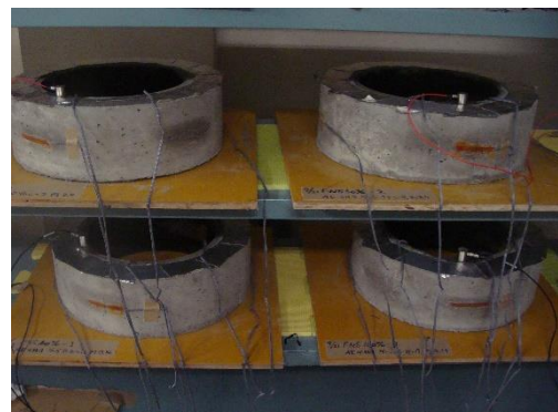
写真-1 リング試験および AE 計測
