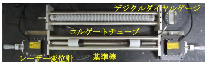
図-1 長さ変化測定装置
