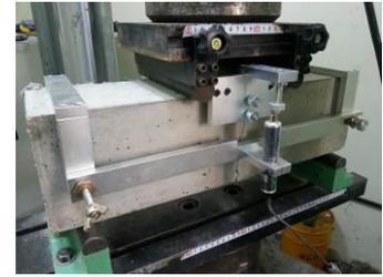
写真-2 引抜試験装置 写真-3 曲げ特性試験装置
