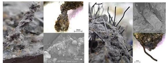
(a) ポリアミド繊維補強コンクリート (b) フック型鋼繊維補強コンクリート
