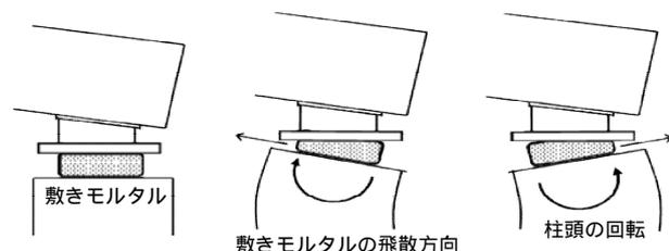
図 - 5 柱頭の回転による敷きモルタルの偏心圧縮作用
