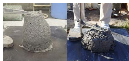
(a) 冬期 (8cm) (b) 夏期 (15cm) 写真 1 スランブ試験の状況
