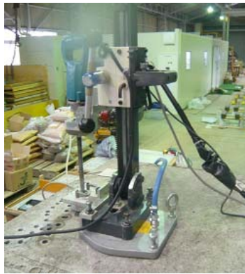
写真-3 既設試験体における下向き穿孔実験の様子
