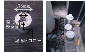
写真-2 コア試験体写真
