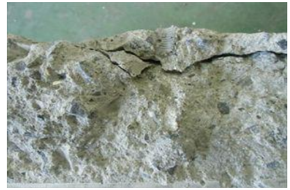
写真－２ 引抜き試験後の試験体の状況（ひび割れ先導入 幅 0.3mm 引抜き耐力 37.5kN） 左；試験体表面 中；ひび割れ割裂面① 右；ひび割れ割裂面②
