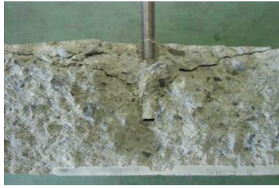
写真－２ 引抜き試験後の試験体の状況（ひび割れ先導入 幅 0.3mm 引抜き耐力 37.5kN） 左；試験体表面 中；ひび割れ割裂面① 右；ひび割れ割裂面②
