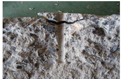
写真－３ 引抜き試験後の試験体の状況（ひび割れ後導入 幅 0.3mm 引抜き耐力 19.8kN） 左；試験体表面 中；ひび割れ割裂面① 右；ひび割れ割裂面②
