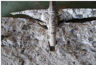
写真－３ 引抜き試験後の試験体の状況（ひび割れ後導入 幅 0.3mm 引抜き耐力 19.8kN） 左；試験体表面 中；ひび割れ割裂面① 右；ひび割れ割裂面②
