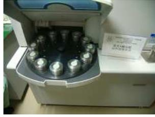
写真 - 2 蛍光 X 線分析装置による溶出量の測定状況
