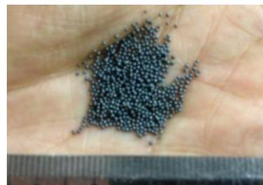
写真-1 細骨材として使用した鉄粒粉
