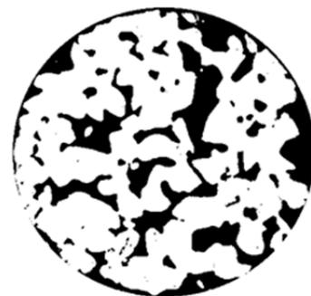
図-3 円柱PoC供試体の切断面の二値化画像
