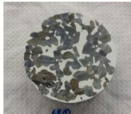
写真-5 円柱PoC供試体の切断面
