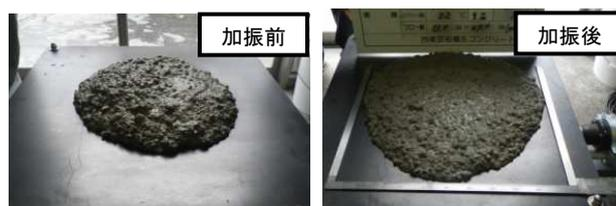
図-1 加振変形試験の状況
