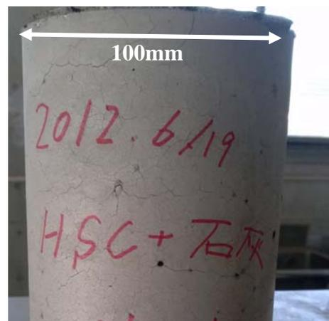
図-2 供試体のひび割れ状況(配合C, 加熱温度500°C)
